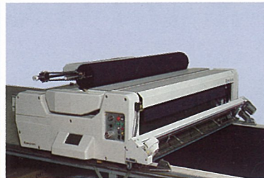
②延反機は走行を開始し、素材の巻戻しを行います。
