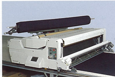
⑥アームが下降し始め、やがて180度の旋回を終了します。
