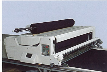
⑦旋回終了後、アームは下降し素材を自動的にセットし延反を開始します。
